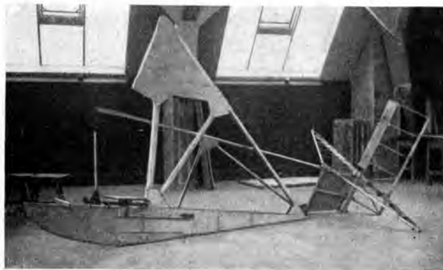
Bild 30 Spannturm und Gitterschwanz mit unbezogenem Höhen- und Seitenleitwerk
