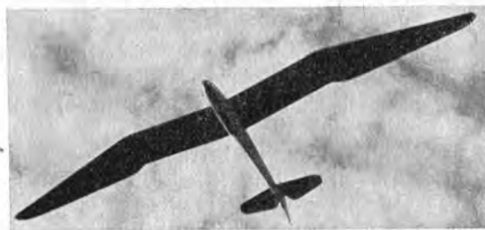
Bild 15 Form der Flügel eines Segelflugzeugs (Münimoa) Seitenverhältnis 1/16
