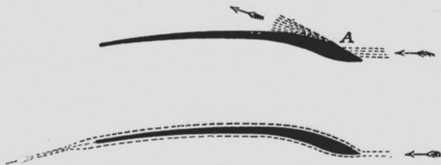
FIG. 92. — Les aéroplanes très étroits, dits « sustentateurs », de M. Phillips.
